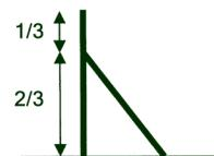
4) Vzdálenost sloupků je max. 3m a všechny rohové a koncové sloupky musí být opatřeny vzpěrami. Je-li oplocení delší než 25m, doporučujeme opatřit každý průběžný sloupek 2 vzpěrami pro lepší stabilitu plotu. Napínací dráty pletiva, které se kotví k rohovým a koncovým sloupkům jsou umístěny nahore, uprostřed a dole. Vzpěra se uchycuje pomocí objímky ke sloupku.
