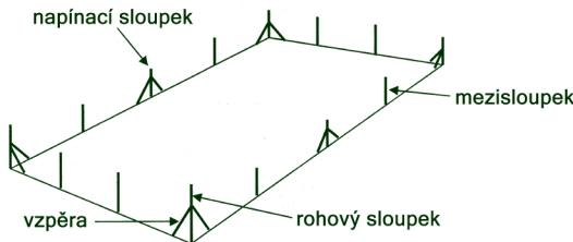
2) Napínací sloupky (doporučujeme použít  $\varnothing 48\text{mm}$ ) se používají na začátku a konci oplocení s 1 vzpěrou, na každém rohu se 2 vzpěrami a průběžně každých 25-30m se dvěma vzpěrami.
