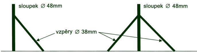
3) Mezisloupy se umisťují mezi napínací sloupky ve vzdálenosti 3m u pletiva výšky do 160cm a 2,5m u vyšších pletiv, vzpěry se připevňují ke sloupkům ve výšce 2/3 jeho nadzemní výšky, pomocí objímky a šroubu. Před uchycením (zavěšením) pletiva, musí být napínací dráty a napínáky nataženy mezi sloupky.
