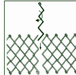
Na horním a dolním okraji pletiva odehneme a rozpleteme spojení dvou sousedních drátrů a krouživým pohybem vypleteme krajní drát (plochou spirálu), přiložíme k sobě dva konce pletiva, které chceme spojit a šroubovitým pohybem vpleteme zpět volnou spirálu.
